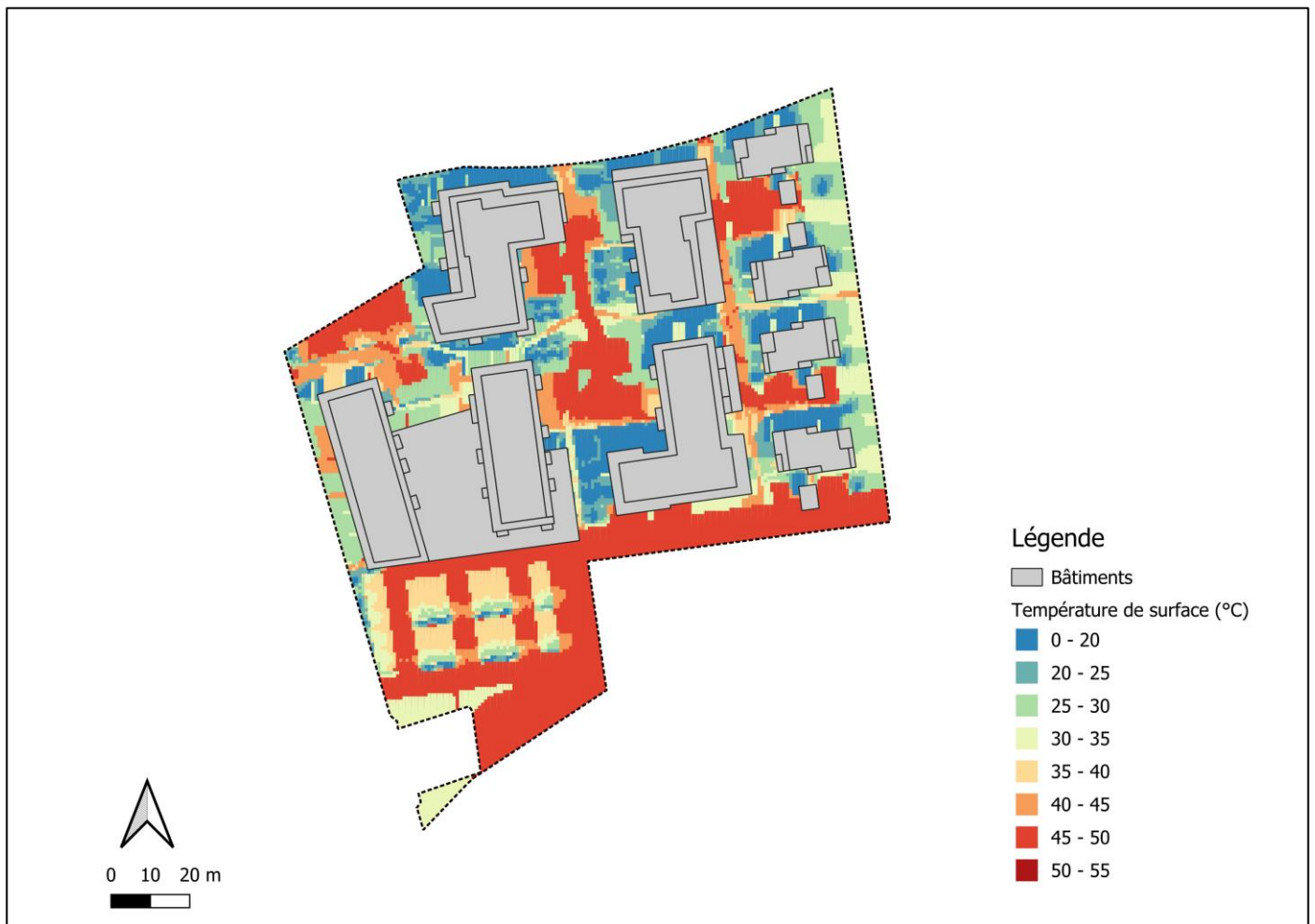
Figure 10 : Cartographies des températures de surface maximales simulées à l'échelle de la journée du 21/07 du fichier météo de Rouen POE10 RCP4.5 2050.
